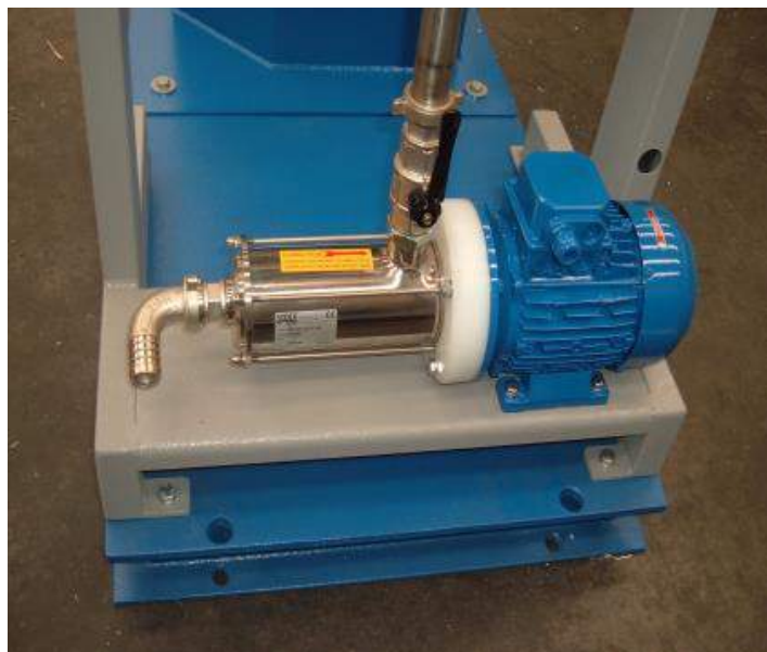
Slika 11. Tank za prikupljanje ulja iz centrifuge s vibro sitom i pumpa za dobavu ulja iz vibro tanka do verikalnog separatora
