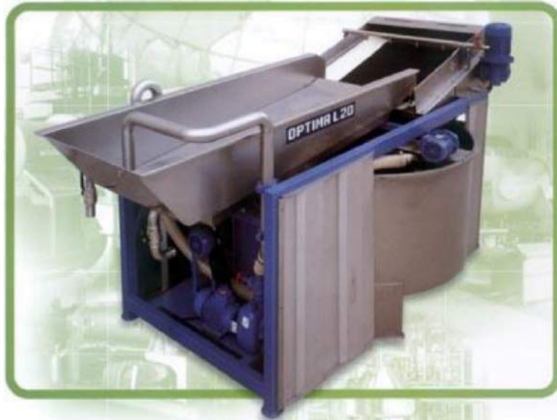
Slika 5. Inox peračica s uređajem za separaciju kamenja
